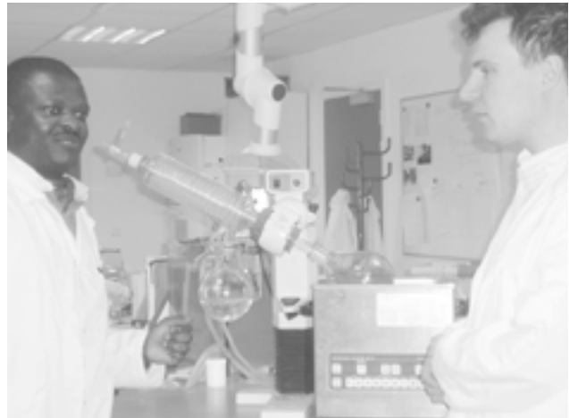
Figure 2 - Evaporation de l'extrait brut d'artémisinine dans un Rotavapor Bibby RE200.
